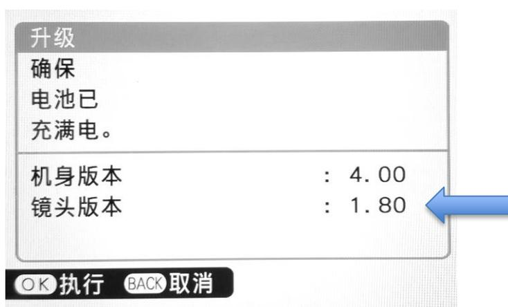
**注意：**第二代产品的固件是在第一代产品的 **2.80** 固件基础上开发的，但是两者并不兼容，请注意区分，一代固件的文件名以 **EFFX** 开始，二代固件的文件名以 **EFX2** 开始。使用错误版本的固件并不会损坏转接环，但固件无法安装。
